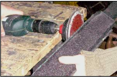
Oben: Zurechtschleifen der "Waffel" mittels Bohrmaschine mit Aufsatz.
